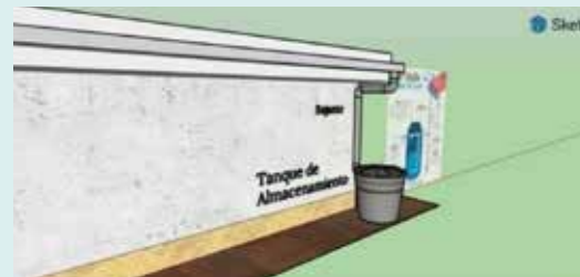
Ilustración 3. Diseño del sistema de recolección de aguas lluvias con tanque de almacenamiento.
