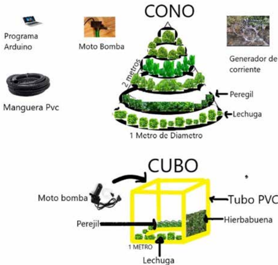
Ilustración 4. Esquemas- planos de los montajes de las formas geométricas para los cultivos hidropónicos.
